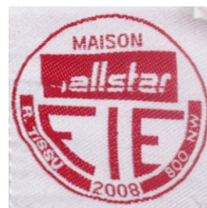
Aufnäher mit FIE-Prüfsiegel für die Durchstoßfestigkeit von 800 N/cm 2 auf einer Fechtjacke.
